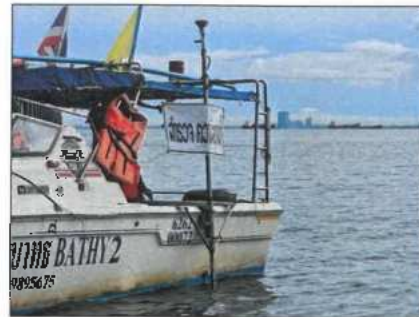
รูปที่ 40 ติดตั้งเสาอากาศเครื่อง GNSS และ Transducer
