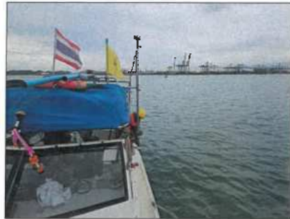
รูปที่ 40 ติดตั้งเสาอากาศเครื่อง GNSS และ Transducer
