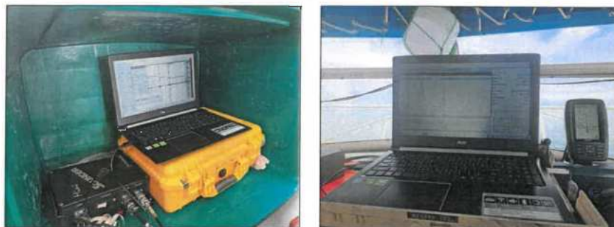
รูปที่ 17 สำรวจค่าระดับพื้นท้องน้ำด้วย ECHO SOUNDING (ต่อ)
