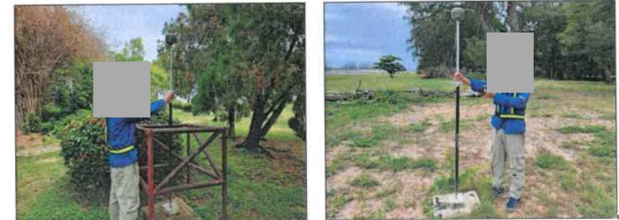
รูปที่ 16 สำรวจค่าระดับพื้นดินด้วย GNSS - RTK
